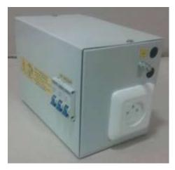
Ящик трансформаторный понижающий (ЯТП) предназначены для питания сетей местного освещения напряжением 12В, 24В, 36В, 42В, а также для подключения переносных светильников и электроинструмента. Номинальная мощность ЯТП, ЯТПР может находиться в пределах от 0,1кВА до 1,6кВА. Питающее напряжение ЯТП не должно превышать 1000В.
